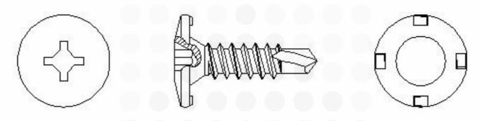
PHILLIPS & SQUARE COMBINATION RECESS TRUSS HEAD WITH SERRATIONS UNDER HEAD SELF DRILLING SCREWS
